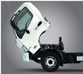
откидывающаяся КАБИНА * Доступна для моделей с однорядной кабиной.
