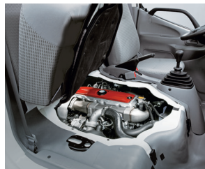
СЪЕМНАЯ ПАНЕЛЬ ДЛЯ ОСМОТРА ДВИГАТЕЛЯ * Доступна для моделей с двухрядной кабиной.
