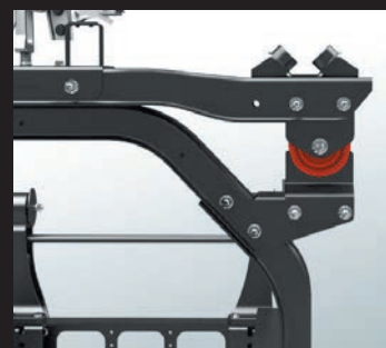
Полузависимая подвеска кабины для FM
