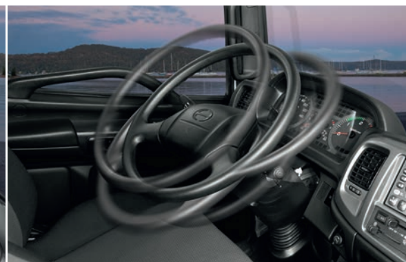
Регулировка рулевой колонки в 2-х направлениях
